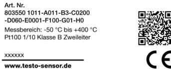
Etikett für Kabelfühler (als Fähnchen am Kabel befestigt)
