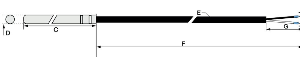
**Ausführung mit Mini-TE-Stecker / Version with mini-TC connector**
