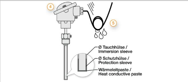
Bitte verlegen Sie das Kabel so, dass kein Wasser in den Fühler eindringen kann und mit Reserveschleufe (4). So können Sie den Fühler ausfahren ohne den elektrischen Anschluss zu lösen.
