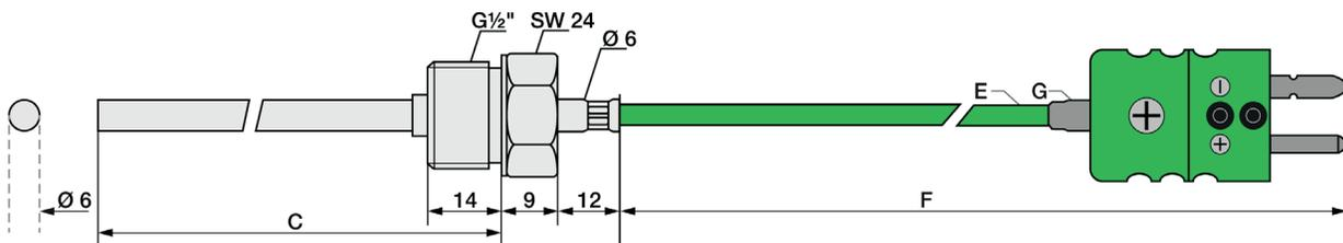
**Ausführung mit Mini-TE-Stecker / Version with mini-TC connector**
